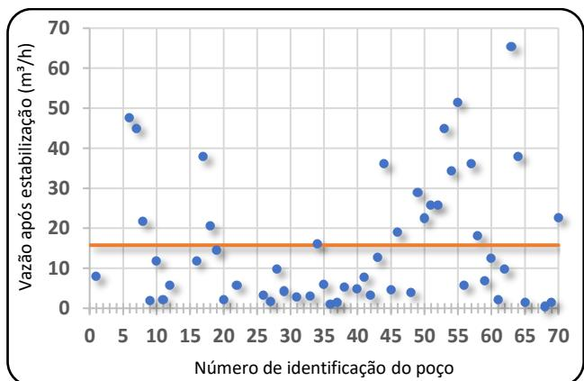
Figure 3 – Vazão após estabilização (pontos na cor azul) e o valor da média 15,77 m<sup>3</sup>/h (linha na cor laranja).
