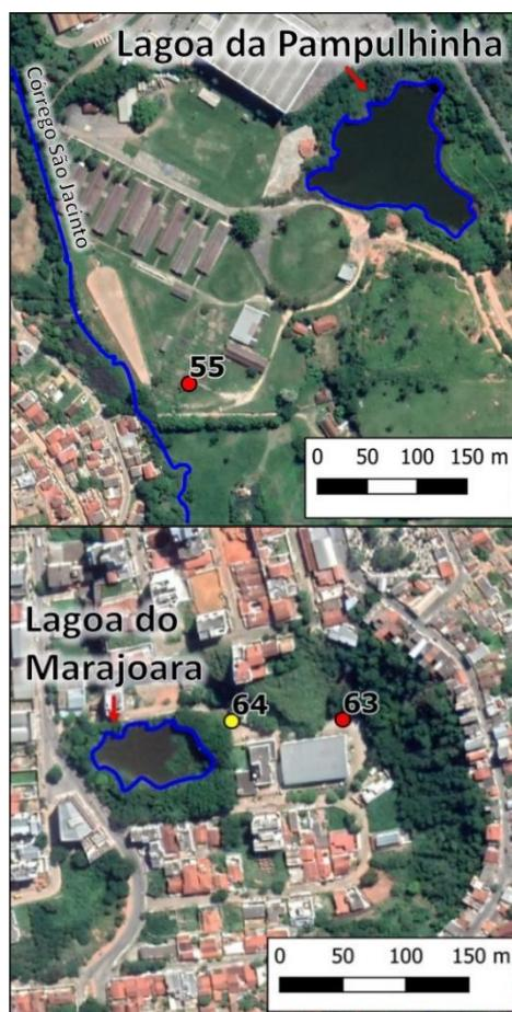
Figura 7 – O Poço 55 está localizado a cerca de 220m da Lagoa da Pampulhinha (painele superior) e o poço 63 a 120m da Lagoa do Marajoara (painele inferior). Ambas as lagoas são uma provável fonte de recarga para os dois poços de maior vazão na região de estudo.
