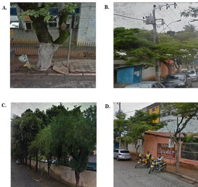
Figura 6 – Principais Interferências urbanas encontradas no bairro Marajoara devido à falta de planejamento no processo de arborização. (A) Quebra da calçada, (B) Rede de energia, (C) Conflitos com outras árvores, e (D) Redução da visibilidade da sinalização de trânsito.
