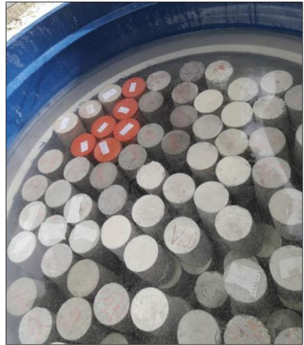
Figura 5 – Cura do concreto.
