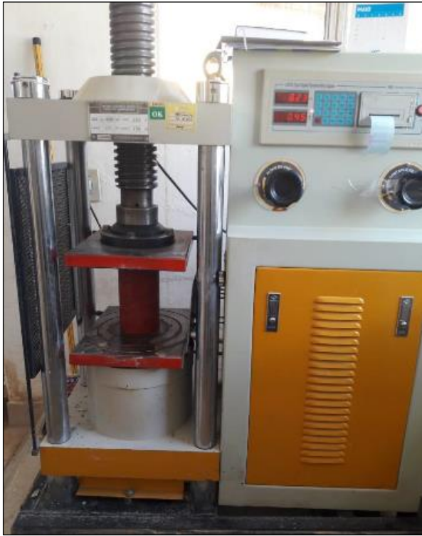
Figura 7 – Rompimento dos Corpos de prova em prensa elétrica digital da marca Solocap.
