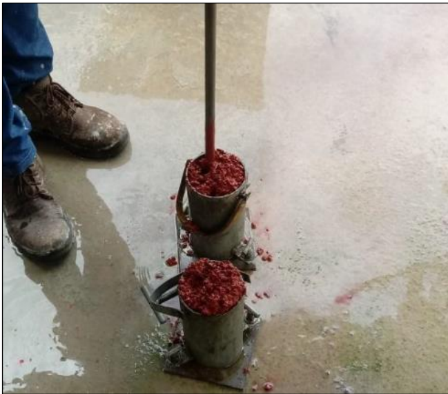
Figura 3 – Abatimento do concreto no corpo de prova.
