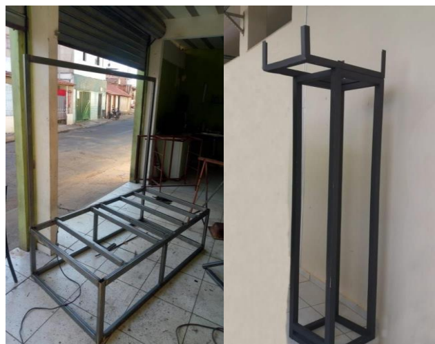
Figura 1 – À esquerda suporte dos aparelhos sanitários e tubulações de esgoto. À direita suporte retrátil para o reservatório.
