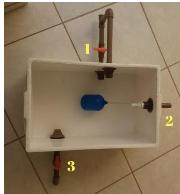
Figura 7 – Vista superior do reservatório. Os números 1, 2 e 3 representam o registro de esfera, a tubulação de alimentação e de abastecimento, respectivamente.
