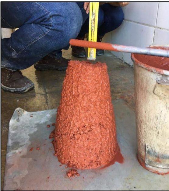
Figura 5 – Slump Test do concreto colorido.
