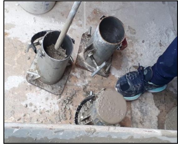
Figura 6 – Abatimento do concreto no corpo de prova.
