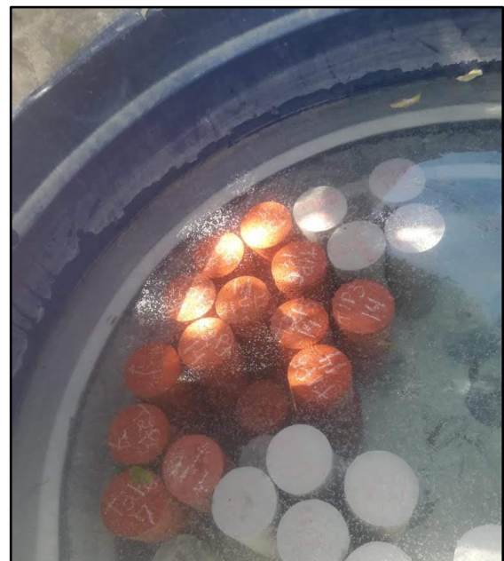
Figura 7 – Cura do concreto.
