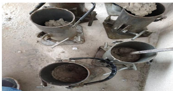
Figura 4 – Moldagem dos corpos de prova.
