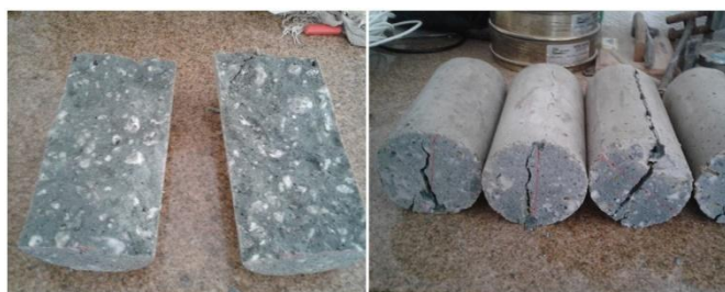
Figura 13 – Corpos de prova sem fibra e com fibra após a compressão diametral
