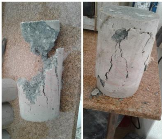
Figura 11 – Corpos de prova sem fibra e com fibra após a compressão uniaxial.
