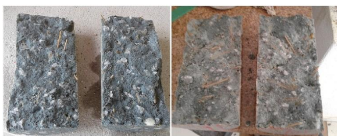
Figura 14 – Visualização das fibras o concreto rompido.
