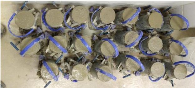
Figura 3 – Moldagem dos corpos de prova.
