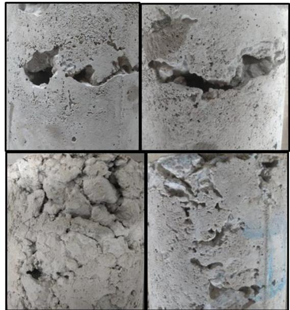
Figura 169 – Conjunto de vazios nos corpos de prova.
