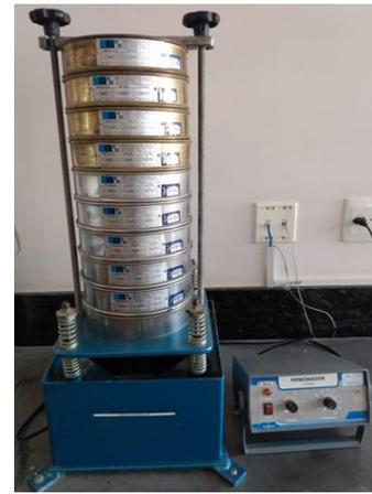
Figura 14 – Ensaio granulométrico dos agregados.
