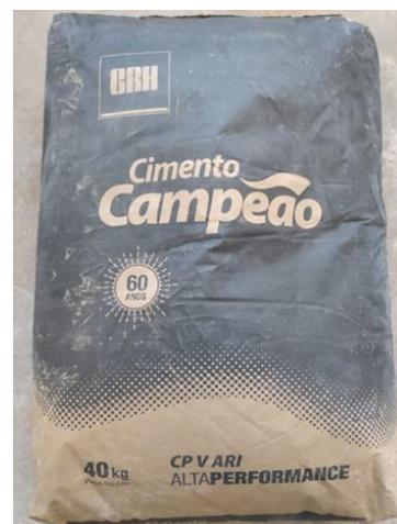
Figura 10 – Cimento utilizado para confecção dos corpos de prova.
