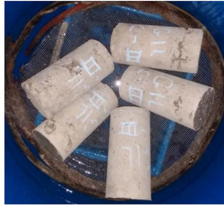
Figura 6 – Cura em câmara úmida.
