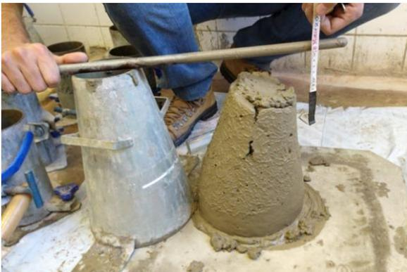
Figura 158 – Abatimento do tronco de cone.
