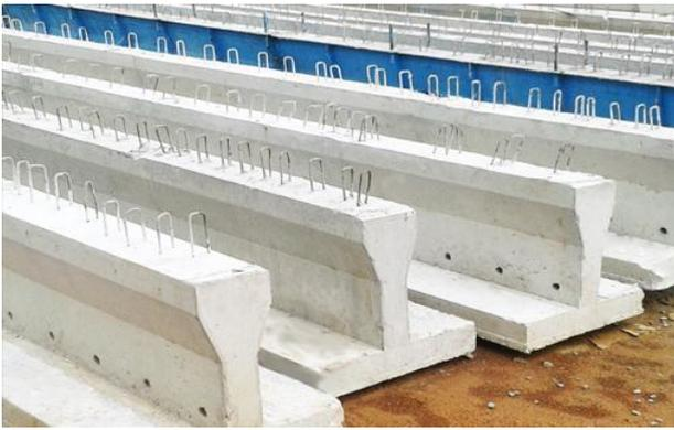
Figura 9 – Viga T em concreto armado. (Construtora Atlântica, 2021).
