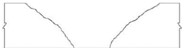
Figura 17 – Situação final do corte provocado por galgamento, com a ruptura da barragem (Jónatas, 2013).
