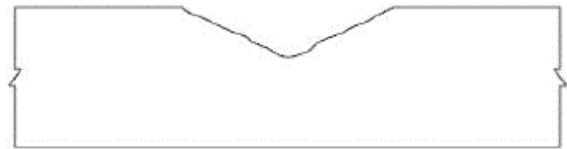
Figura 15 – Situação inicial do corte provocado por galgamento (Jónatas, 2013).
