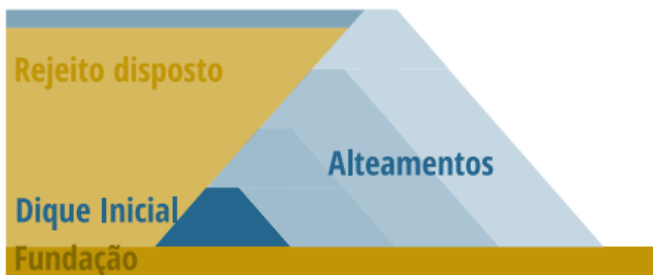
Figura 8 – Seção típica barragem de rejeitos no método de alteamento a jusante (ANA, 2019)
