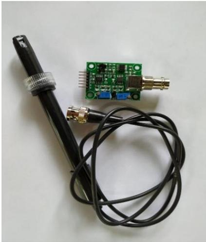
Figura 1 – Módulo e sensor de pH.
