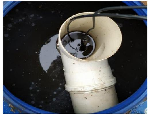
Figura 11 – Posição dos sensores na terceira bombona.
