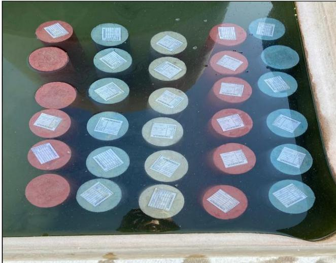
Figura 5 – Cura dos corpos de prova.
