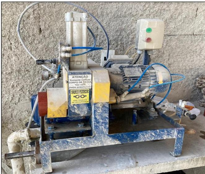
Figura 6 – Retificação dos corpos de prova.
