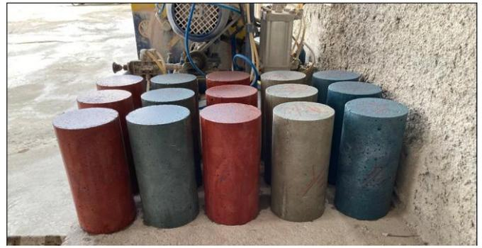
Figura 7 – Corpos de prova retificados.
