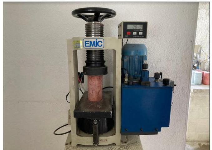
Figura 9 – Ensaio de resistência à compressão.
