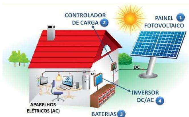
Figura 2 – Funcionamento de um sistema off-grid (Neosolar, 2022).
