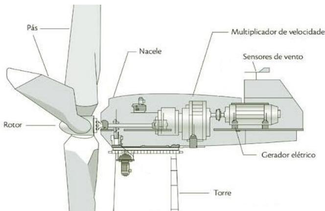
Figura 3 – Estrutura de um aerogerador (Windbox, 2020).
