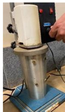
Figura 10 – Amostra do solo no dispersor de solos.
