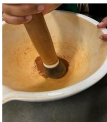
Figura 7 – Destorração da amostra do solo.
