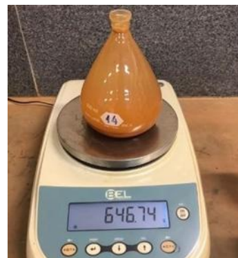
Figura 14 – Pesagem da mistura com o picnômetro.
