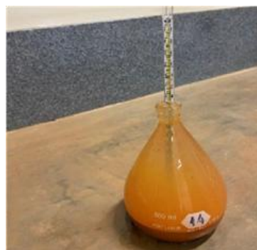
Figura 15 – Aferição da temperatura da mistura.
