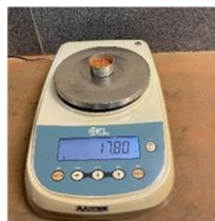
Figura 4 – Pesagem da amostra do solo.
