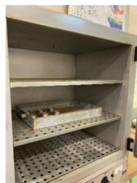
Figura 5 – Amostras do solo sendo colocadas na estufa.
