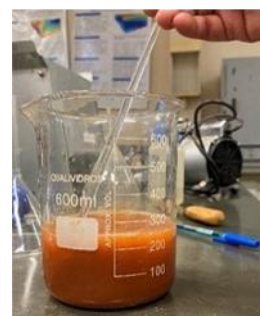
Figura 9 – Diluição da amostra de solo.
