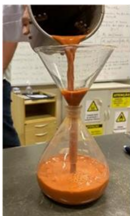
Figura 12 – Introdução da amostra de solo no picnômetro.
