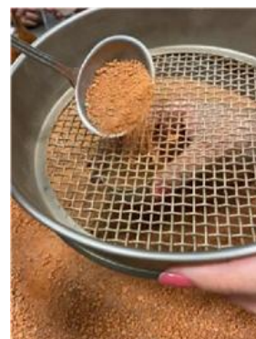
Figura 3 – Peneiramento e tomada da amostra do solo.
