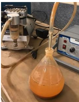
Figura 13 – Amostra de solo na bomba de vácuo.
