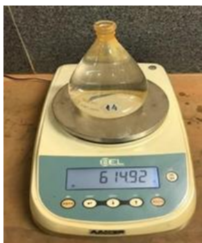
Figura 11 – Pesagem do picnômetro com água.
