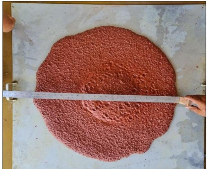
Figura 7 – *Flow-test* 70 obtido no TV3.
