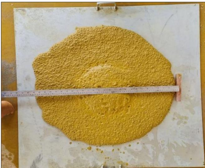
Figura 6 – *Flow-test* 69 obtido no TA5.
