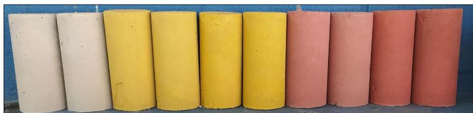
Figura 16 – Demonstração das cores obtidas aos 28 dias, na sequência REF, TA3, TA5, TV3 e TV5.
