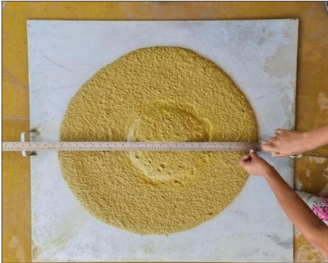
Figura 5 – *Flow-test* 70 obtido no TA3.
