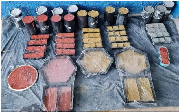
Figura 9 – Corpos de prova moldados.
