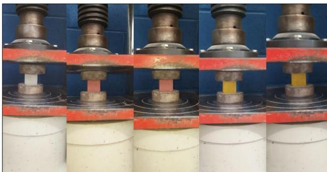
Figura 11 – Rompimento dos corpos de prova.
