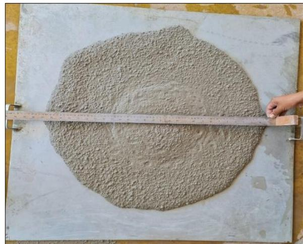
Figura 4 – *Flow-test* 71 obtido no traço de referência.
