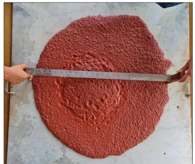
Figura 8 – *Flow-test* 70 obtido no TV5.
