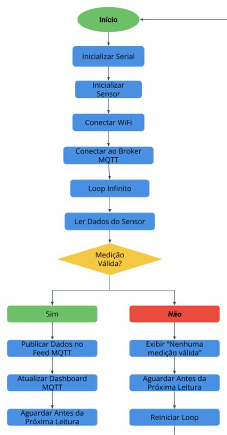
Figura 1 – Fluxograma do funcionamento do sistema.
