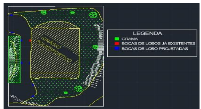
Figura 21 – Sistema de drenagem eficiente.
