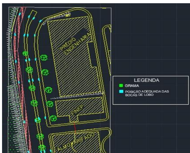
Figura 24 – Posição adequada das bocas de lobo.
