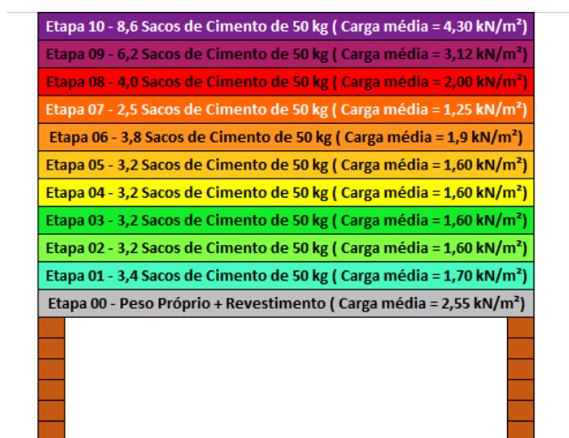
Figura 4 – Representação esquemática das etapas do carregamento da laje pré-moldada.
