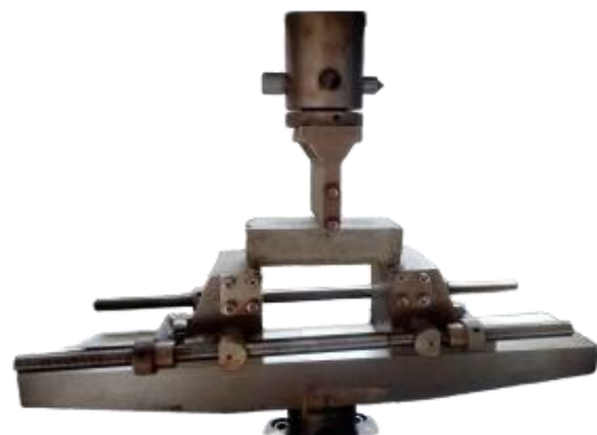
Figura 1 – Suporte padronizado posicionado na amostra antes de aplicar força (Vinolas et al, 2023).
