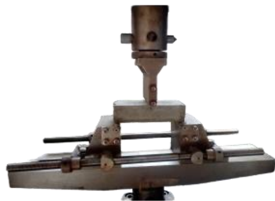
Figura 1 – Suporte padronizado posicionado na amostra antes de aplicar força. Fonte: (Vinolas et al, 2023).
