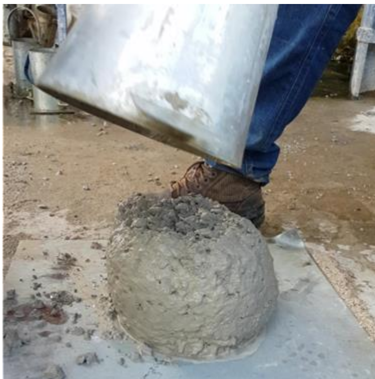
Figura 20 – Retirada do cone - concreto auto-adensável
