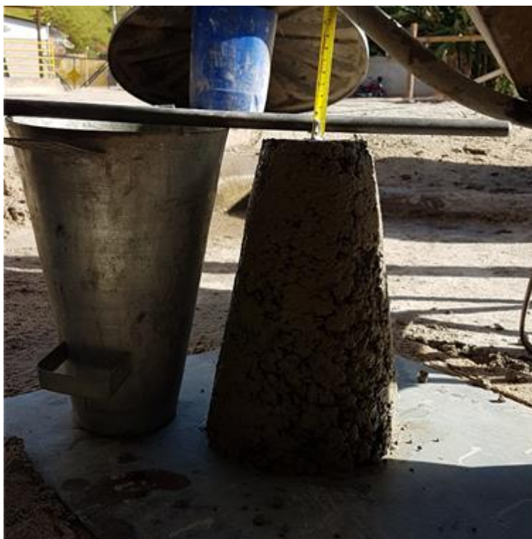
Figura 21 – Abatimento do concreto convencional
