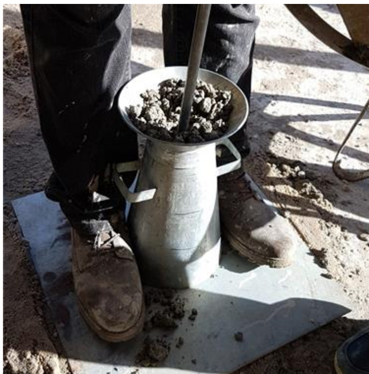
Figura 18 – Socamento do concreto convencional
