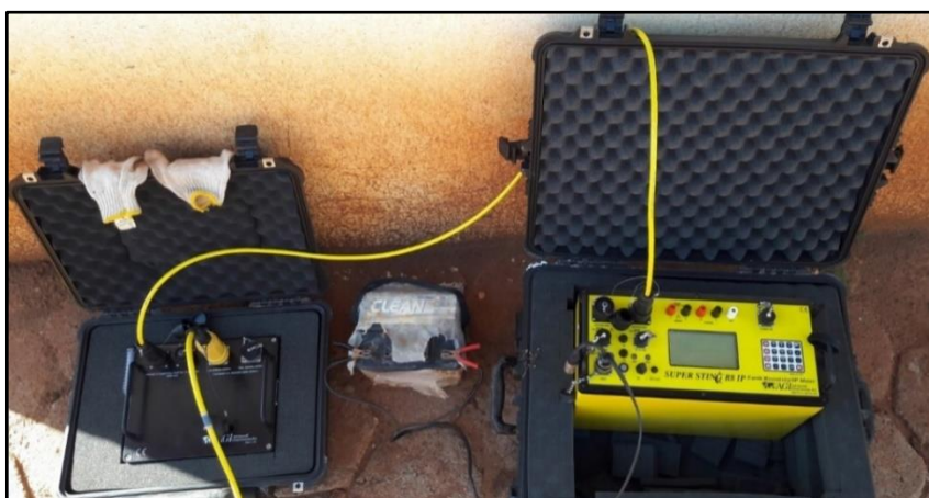
Figura 4 - Resistivímetro (direita) e Switch Box (esquerda).
