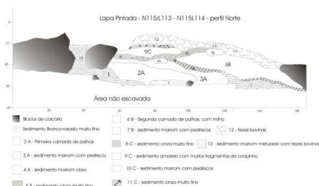
Figura 4. Perfil estratigráfico da Estrutura 1.
