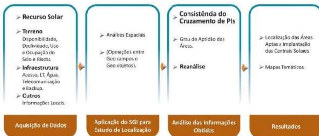
**Figura 4** - Fluxograma de procedimentos para a identificação dos locais mais favoráveis para a instalação de centrais elétricas solares de grande porte.
