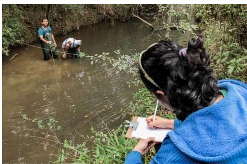
**Figura 1:** Medição de Vazão - Ponto 1
