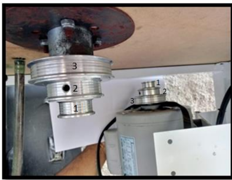
Figura 49 – Sistema de Polias e Correia da Máquina de Lapidar
