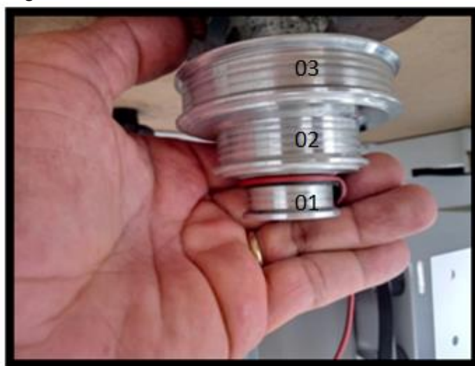
Figura 50 – Medindo a Circunferência das Polias
