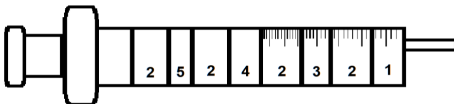
Figura 2 - Esquema da montagem do filtro. 1) Papel filtro; 2) Lã de vidro; 3) Nanomaterial \delta -FeOOH; Biomassas de 4) casca de banana; 5) Pleurotus ostreatus
