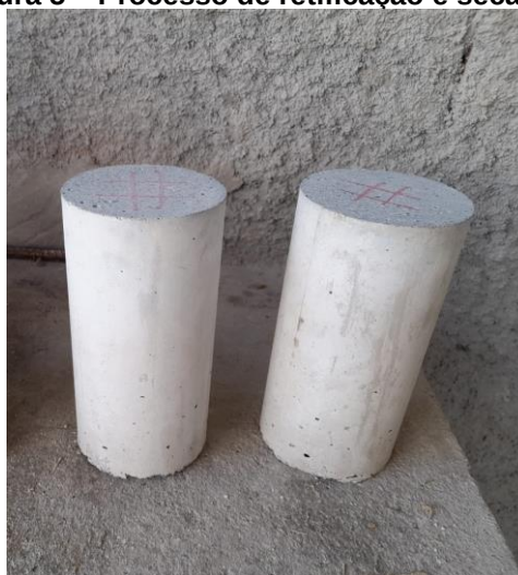
Figura 5 – Processo de retificação e secagem
