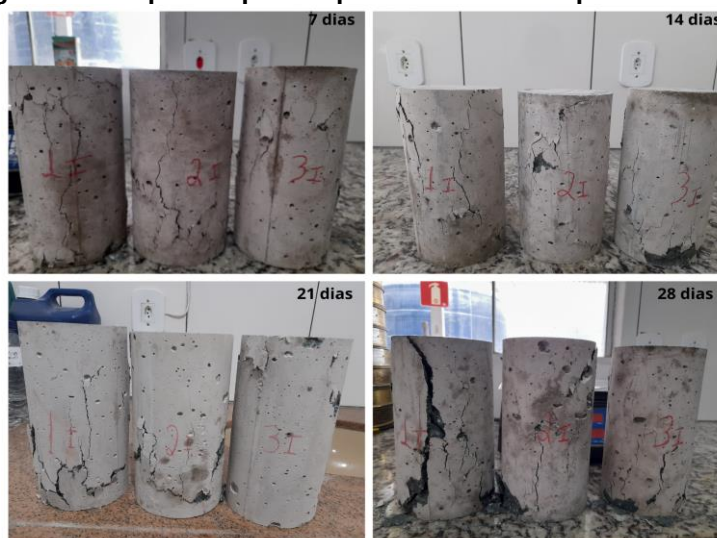
Figura 7 – Corpos de prova após ensaio de compressão – CA 4
