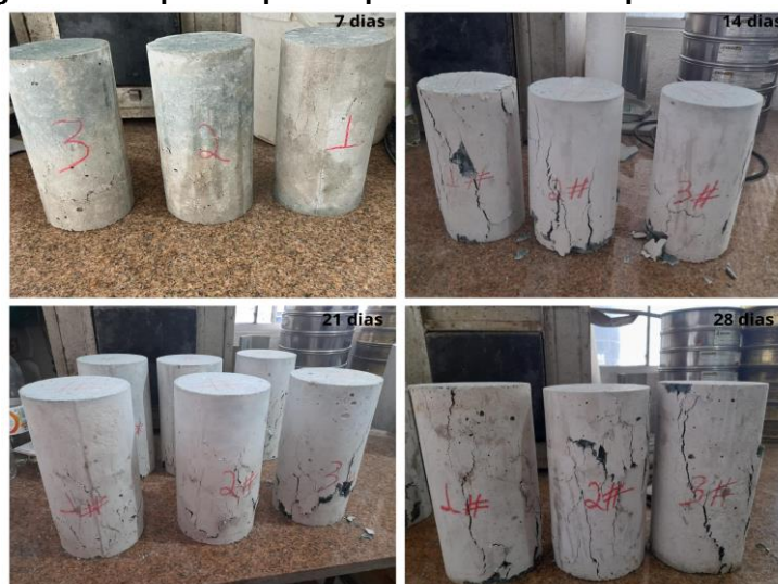
Figura 8 – Corpos de prova após ensaio de compressão – CA 5
