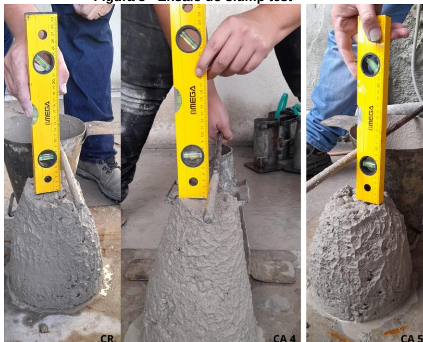
Figura 3 - Ensaio do slump test
