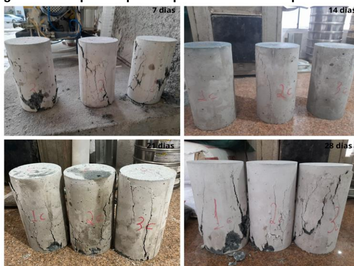
Figura 6 – Corpos de prova após ensaio de compressão - CR
