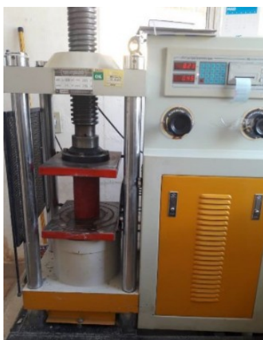
Figura 3 – Rompimento dos corpos de prova do concreto colorido em prensa elétrica digital da marca Solocap na pesquisa de Sousa, Oliveira e Gomes (2020)
