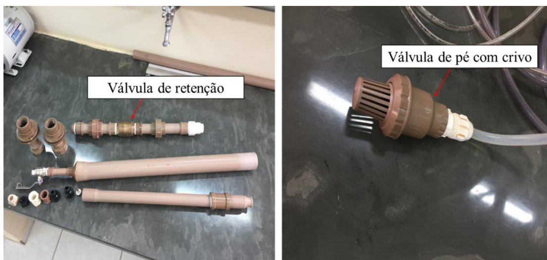
Figura 12 - Alguns equipamentos utilizados na realização do experimento.
