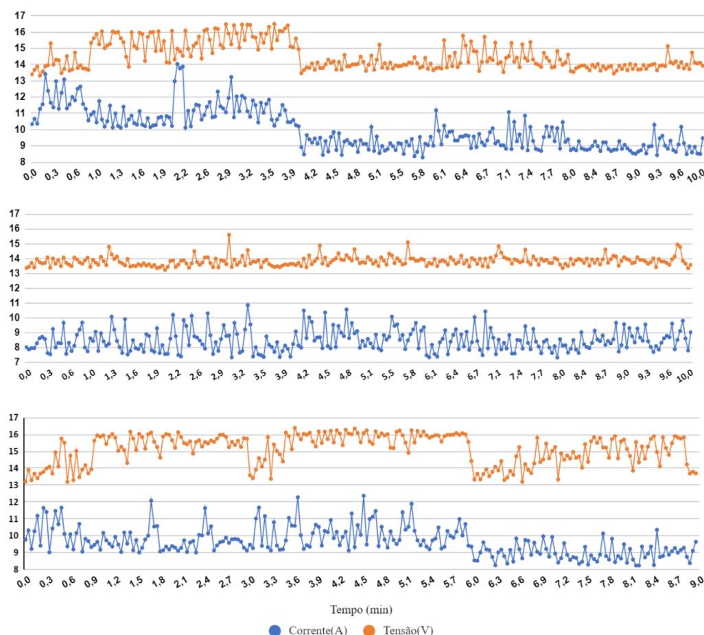
Figura 6 – Gráficos da corrente e da tensão geradas pelas pedaladas pelos voluntários 1 (superior), 2 (do meio) e 3 (inferior) ao longo do tempo.
